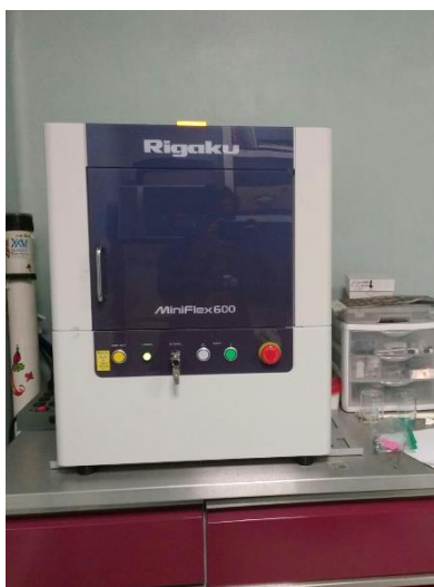
Figura 2.6 Difractómetro de polvos Rigaku Miniflex 600.
