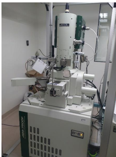
Figura 2.8 Microscopio electrónico de barrido JEOL JSM 7800 F.
