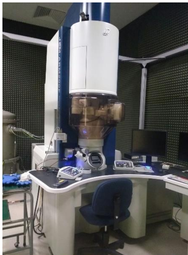
Figura 2.7 Microscopio electrónico de transmisión JEM ARM 200 CF.
