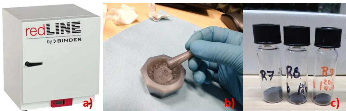
Figura 2.5 Secado de nanopartículas, a) Horno de secado RedLine Binder RE 115, b) Molienda de producto seco en mortero de cuarzo, c) Muestras almacenadas en viales de vidrio.
