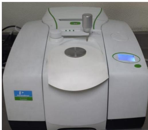
Figura 2.5 Espectrofotómetro de Transformada de Fourier, Frontier Perkin Elmer.
