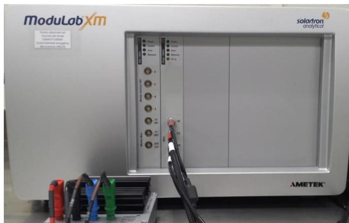
Figura 2.3 Potenciostato / Galvanostato Solartron Modulab XM
