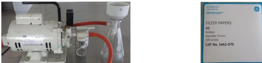
Figura 2.10 Bomba de vacío (derecha) y papel filtro (izquierda).
