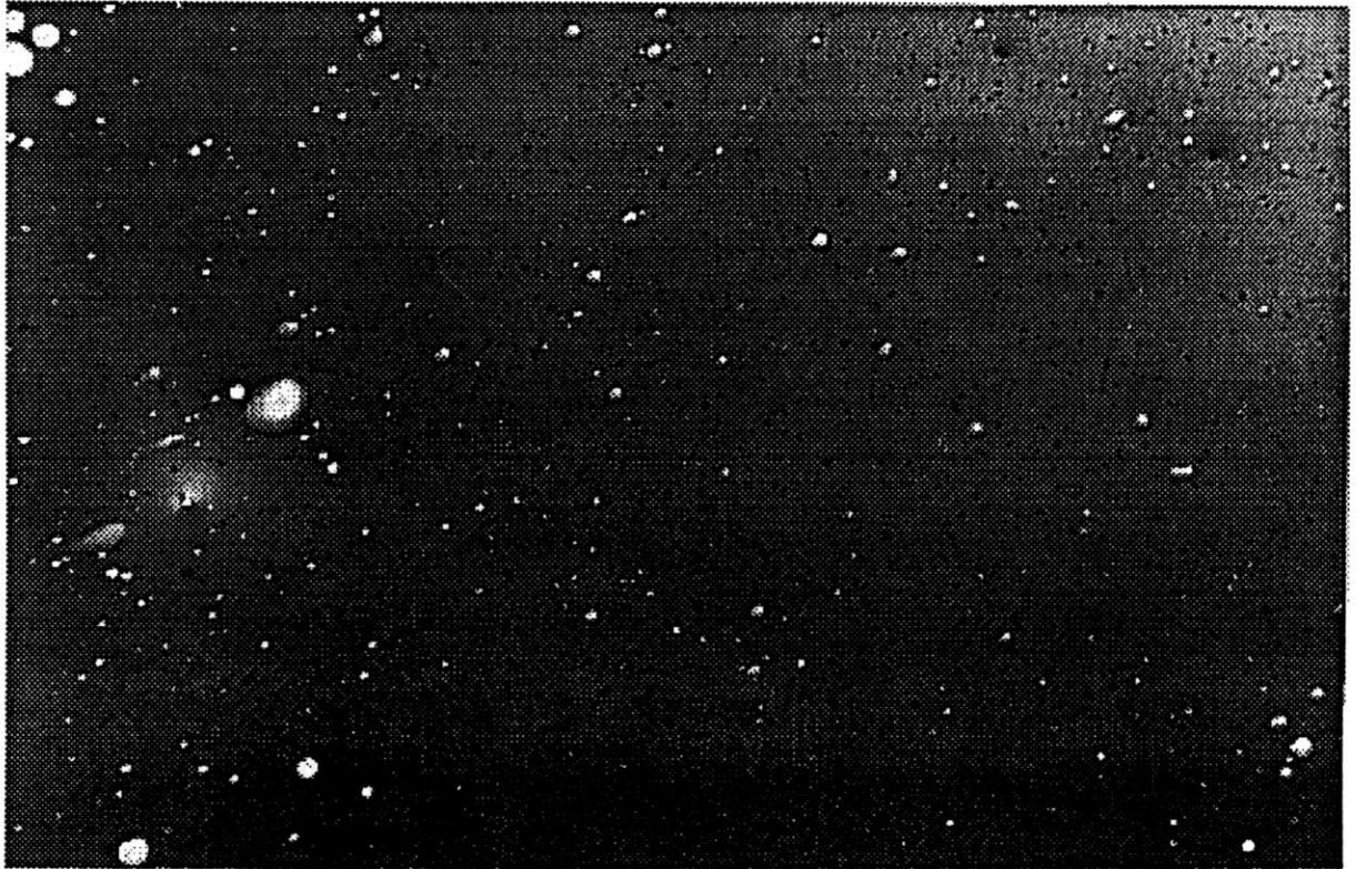
Figura 4.2. Microestructura de una emulsión con 30% de agua.
