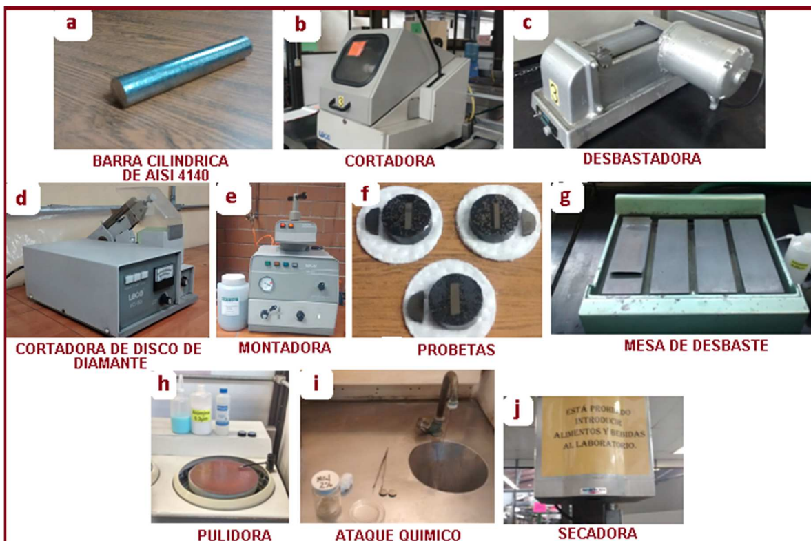
Figura 13. (a) Barra de acero AISI4140 normalizada \Phi 19.05\text{mm} \times 30\text{cm} , (b) cortar probetas de 5mm de espesor, (c) desbastar la rebaba de los filos, (e) cortar muestra por la mitad en sección transversal, (f) montar en baquelita y granallas, (g) desbastar con lijas #80-120-240-360-400-600-1000-1500-2000, (h) pulir con alúmina de 0.03 micras y sílica coloidal de 0.06 micras, (i) atacar con nital al 3% por 3 segundos y limpiar con alcohol, (j) secar con aire caliente.
