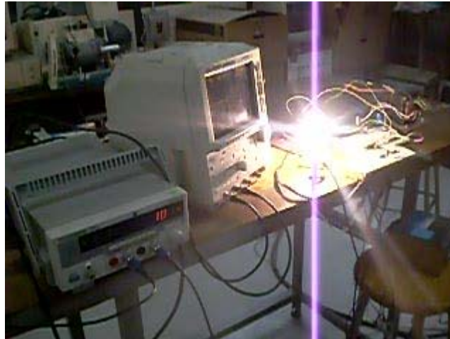
Figura 4.9.- Esta figura muestra al inversor trabajando energizado y alimentando la carga.
