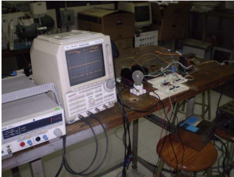
Figura 4.2.- Inverso medio puente en conjunto con el equipo necesario para obtener las señales de salida.
