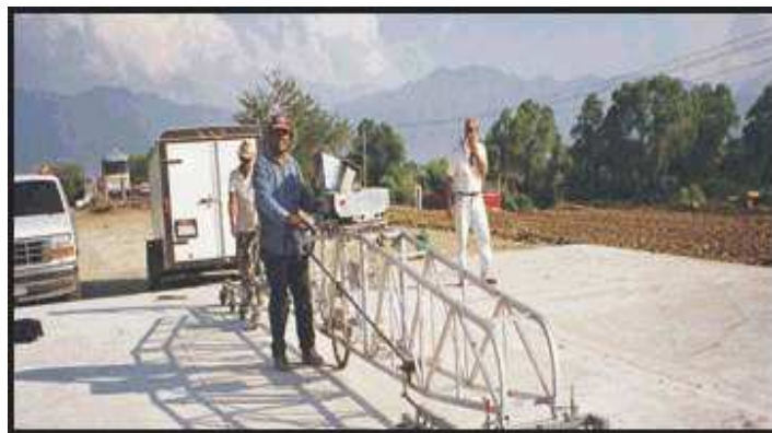
Equipo para medición de calidad de la superficie del pavimento. Perfilógrafo tipo California.
