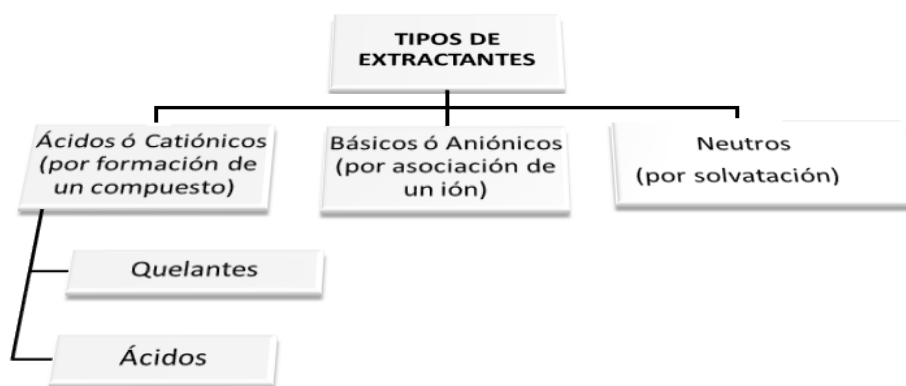
Figura 1. 6 Clasificación de los extractantes o mecanismos por los que se lleva el proceso SX
