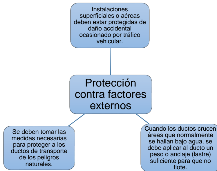
Figura 2.37. Consideraciones para brindar protección a los ductos.
