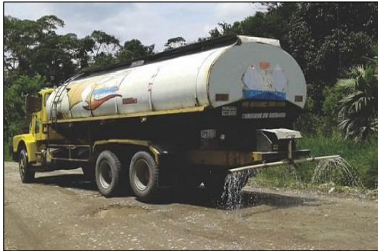
Figura 2.14. Mitigación de polvos mediante el riego de agua tratada (foto original tomada en campo).
