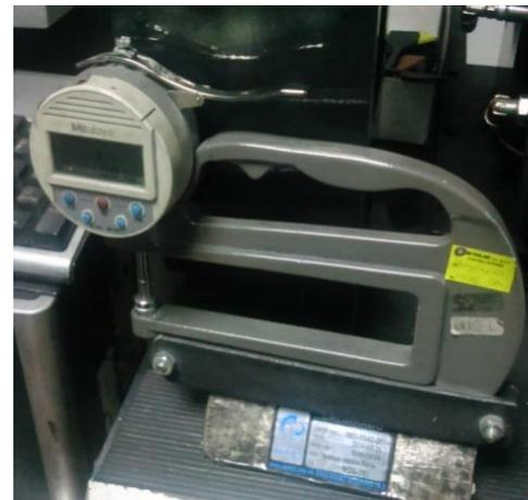
(b) Medidor de espesores
