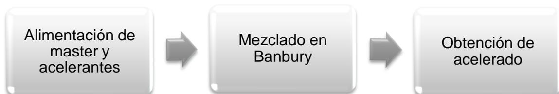
**Figura 42.** Diagrama de bloques del proceso de mezclado de poliisopreno con reacción química
