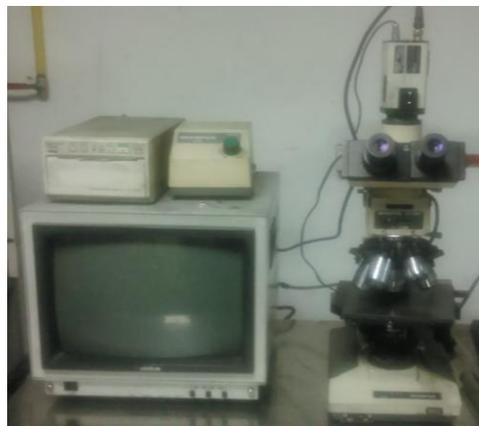
**Figura 24.** Microscopio óptico.
