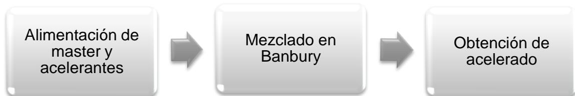
**Figura 35.** Diagrama de producción de un hule con acelerantes.
