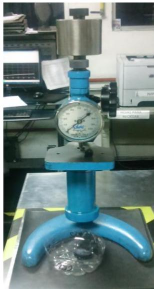
**Figura 31.** Durómetro
