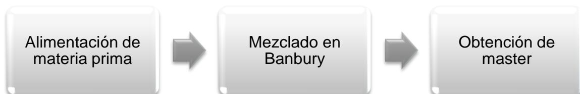
**Figura 34.** Diagrama de producción de un máster de hule
