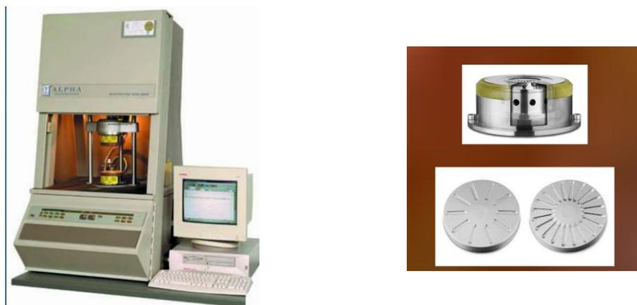
Figura 26. Equipo Reómetro de disco móvil con discos móviles (MDR)
