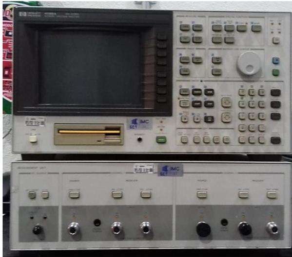
Figura A1.4. Analizador de Redes/Espectro HP modelo 4195A.
