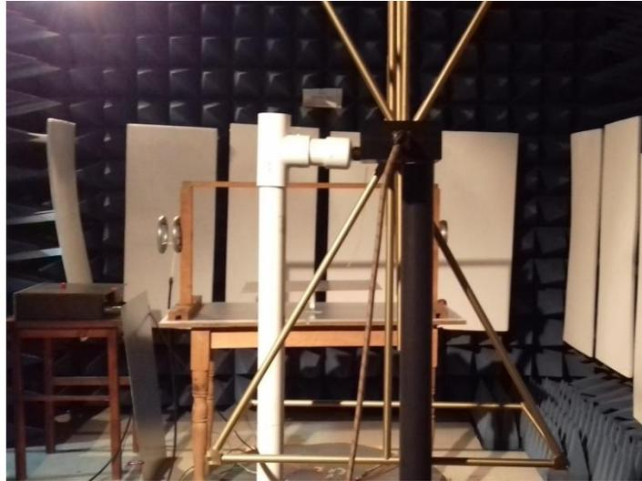
Figura 3.12 Mediciones de las emisiones radiadas empleando la antena log - periódica híbrida: posición 2.
