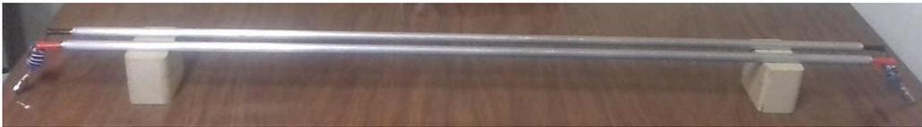
Figura A1.12. Baluns conectados en los extremos del dispositivo de calibración.
