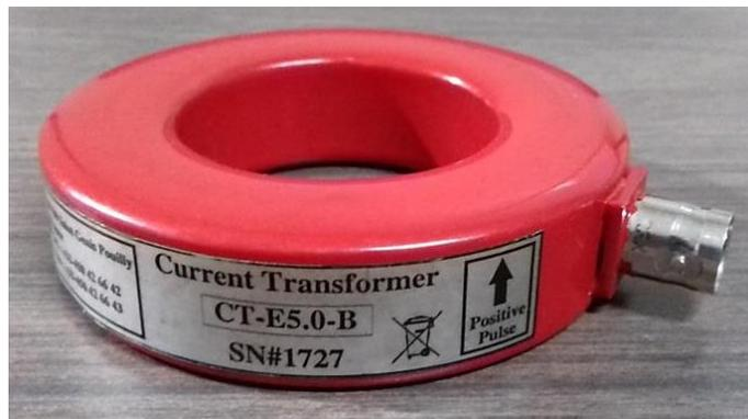
Figura 3.3 Sonda de corriente utilizado en las mediciones en los laboratorios de AT y de CEM.
