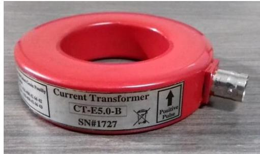
Figura A1.3. Sonda de corriente CT- E5.0 de la marca Bergoz. Tomada de [34]
