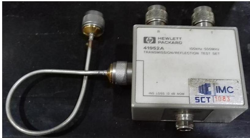
Figura A1.5. Equipo de prueba de Transmisión/Reflexión.
