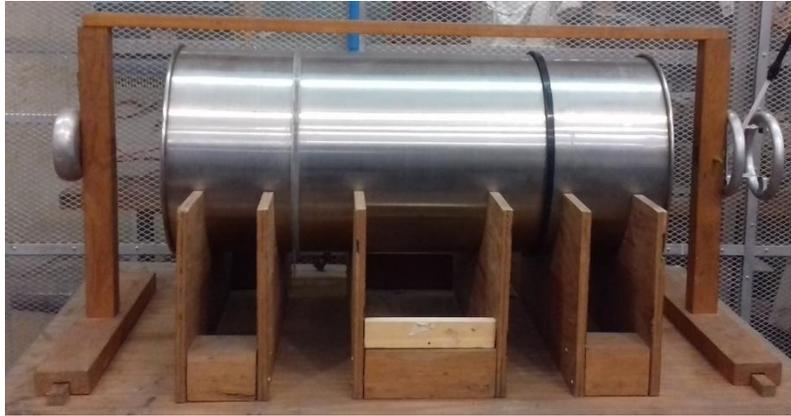
Figura 3.2 Arreglo experimental jaula corona empleado en el laboratorio de AT.
