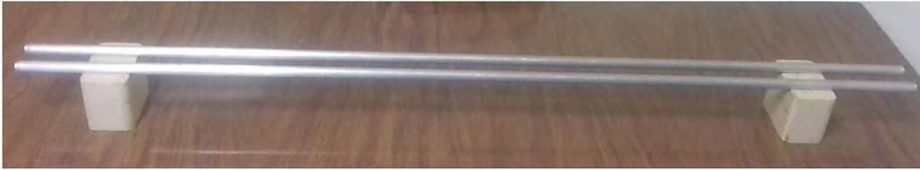
Figura A1.11. Dispositivo de calibración basado en una línea de transmisión.
