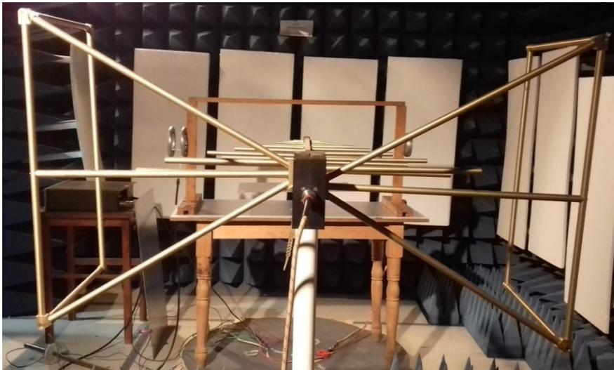
Figura 3.11 Mediciones de las emisiones radiadas empleando la antena log - periódica híbrida: posición 1.
