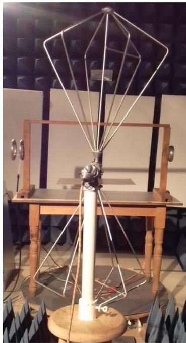
Figura 3.9 Mediciones de las emisiones radiadas empleando la antena bicónica: posición 1.
