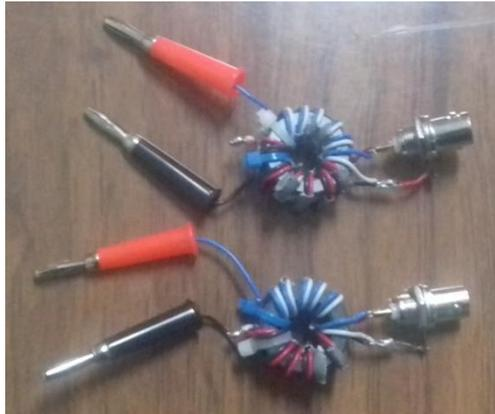
Figura A2.2 Baluns contruidos para la calibración de la sonda de corriente CT - E5.0.
