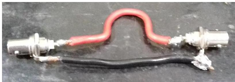
Figura A1.6. Dispositivo de calibración.
