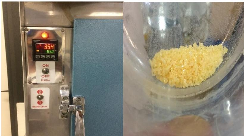
Figura 2.8 Imagen del material seco.
