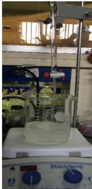
Figura 2.6 Adición de la solución catalítica al precursor con el alcohol.
