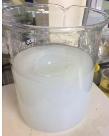
Figura 2.7 Lavado del material obtenido con agua desionizada.
