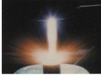
Figura 2.35. Tungsteno rociado térmicamente sobre aluminio (Smith, 2006).
