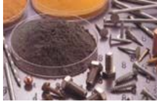
Figura 2.33. Elementos que intervienen en el chapado mecánico (Atotech Deutschland GmbH, 2007).
