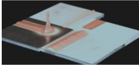
Figura 2.36. Cobre rociado en frío sobre sustratos cerámicos y metálicos (Smith, 2006).
