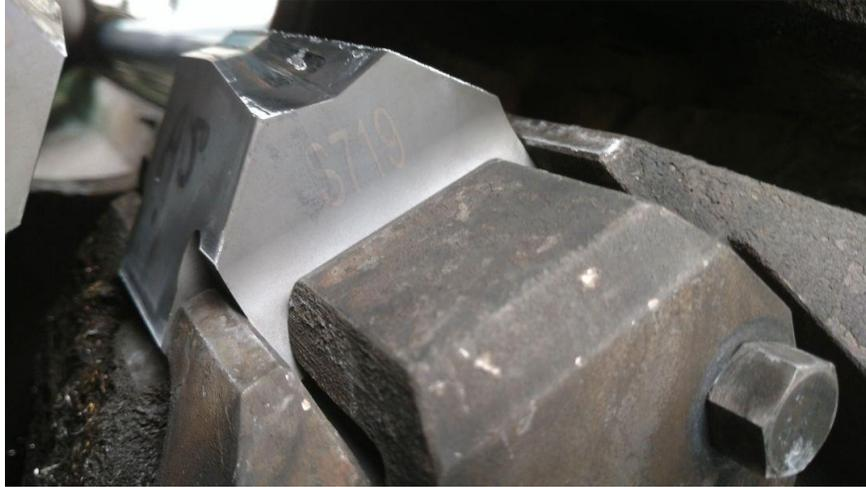
**Figura III.8.-** Desgaste en el perfil de los martillos de forjado
