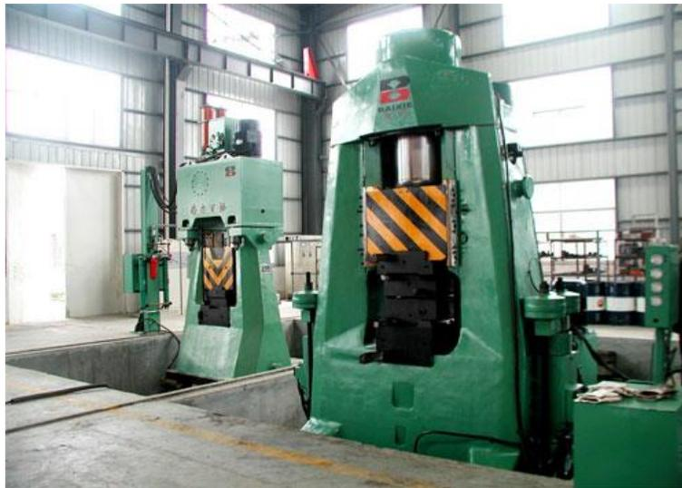
**Figura I.9.-** Martillos de forja hidráulicos
