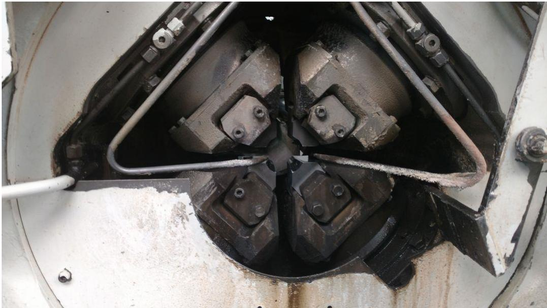
**Figura III.1.-** Caja de forjado con el juego de cuatro 4 martillos y soporte de contador
