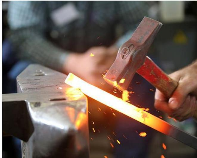
**Figura I.8.-** Proceso de forjado manual
