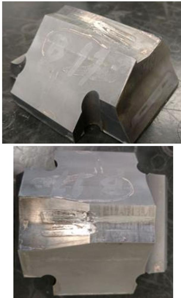
**Figura III.7.-** Falla en el martillo por deformación plástica
