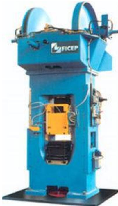
**Figura II.12.-** Prensa de forjado vertical con tornillo de fricción, *Cía. Ficep*
