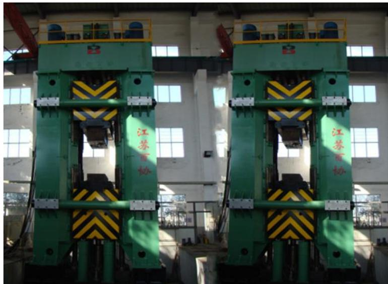
**Figura II.13.-** Martillos de contragolpe hidráulicos para forjado *Jiangsu Baixie Precision Forging Machinery Co., Ltd.*
