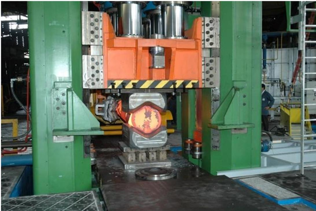
**Figura II.10.-** Prensa de forja hidráulica, *Cía. Fagor Arrasate 2013*
