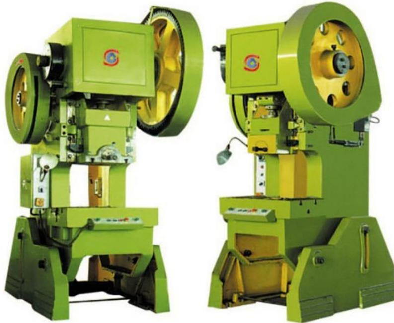
**Figura II.11.-** Prensas de forja mecánicas
