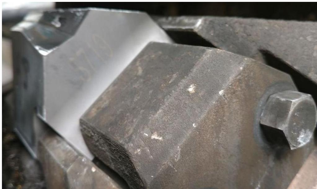
**Figura III.12.-** Sujeción del martillo en la caja de forjado
