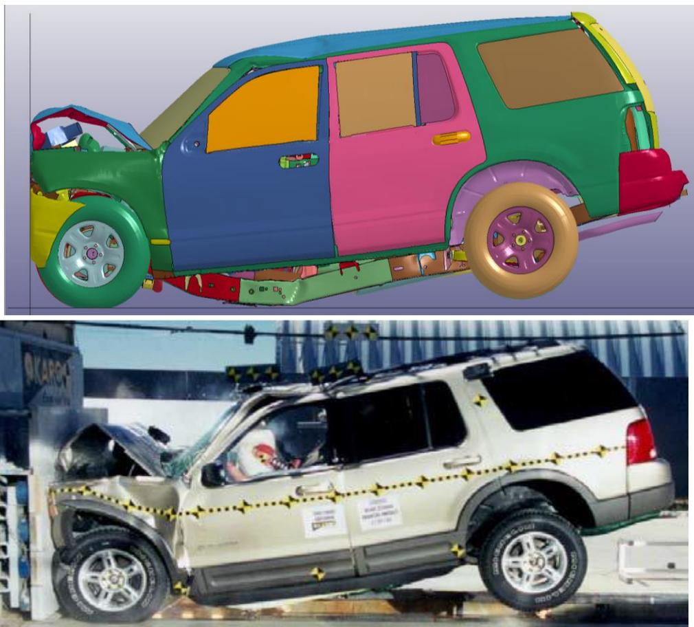
**Figura VI. 1.-** Comparativa colisión frontal del modelo virtual vs prueba experimental
