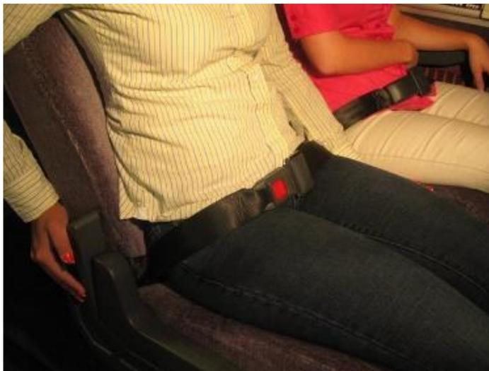
**Figura I. 12.-** Cinturón de seguridad de dos puntos
