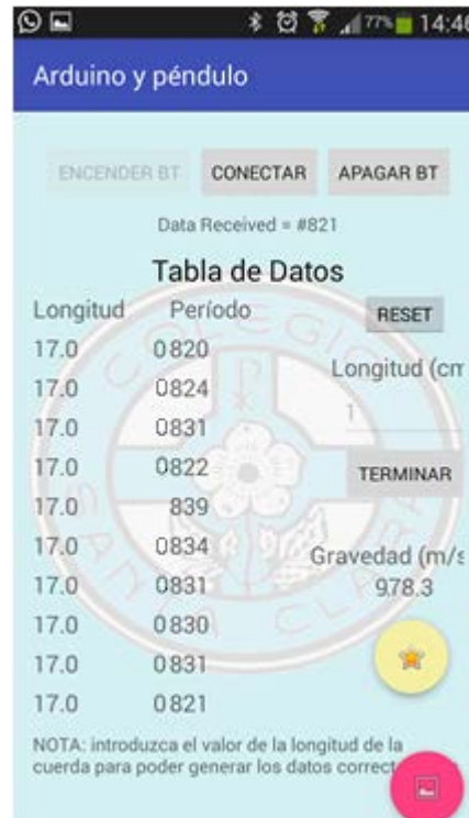
Imagen 16. (Aplicación ArduinoFIX, mostrando el valor obtenido de la gravedad)
