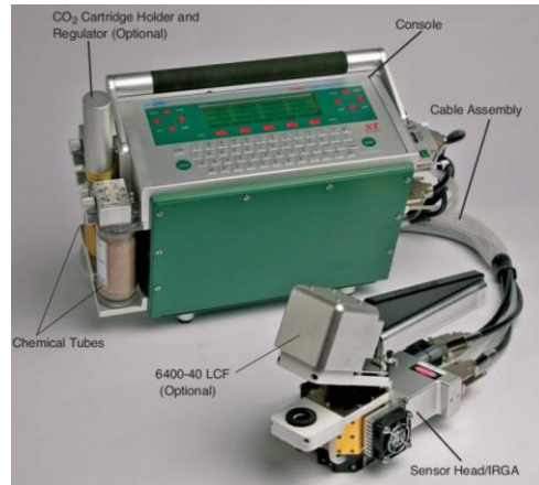
Figura 5. Sistema Li-COR portátil 6400 [44].
