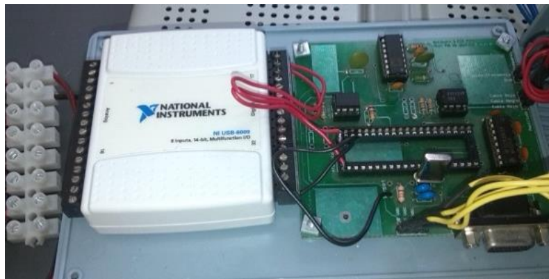
Figura 11, Foto DAQ y circuito generador US.
