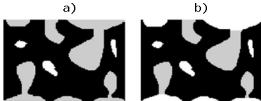
Figura 21. a) Todos los poros incluidos y huecos poco profundos son incluidos en la medición; b) huecos poco profundos a lo largo de la superficie son excluidos de la medición.
