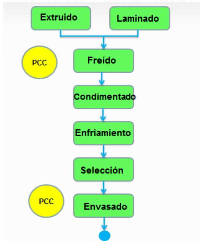
Figura 5. Diagramas de flujo para la elaboración de Extruidos y Laminados.
