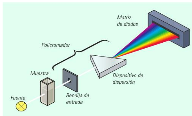
Fig. 12. Diagrama general de un espectrómetro Uv-Vis.
