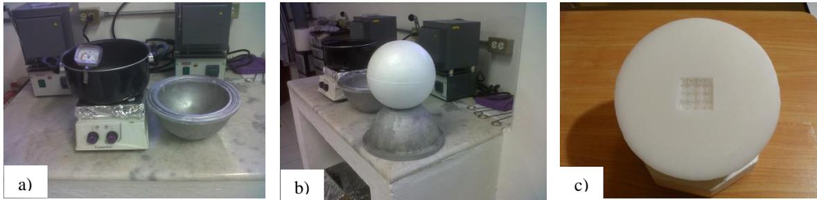
**Figura 4-1 Construcción del medio moderador a) materiales y equipo b) esfera de parafina c) semiesfera y contenedor de acrílico para TLDs.**
