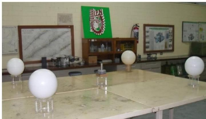
**Figura 4-5** Irradiación de las esferas con la fuente de  $^{239}\text{PuBe}$ .
