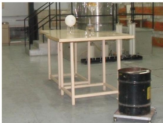
**Figura 4-4** Irradiación del detector con la fuente  $^{239}\text{PuBe}$ .
