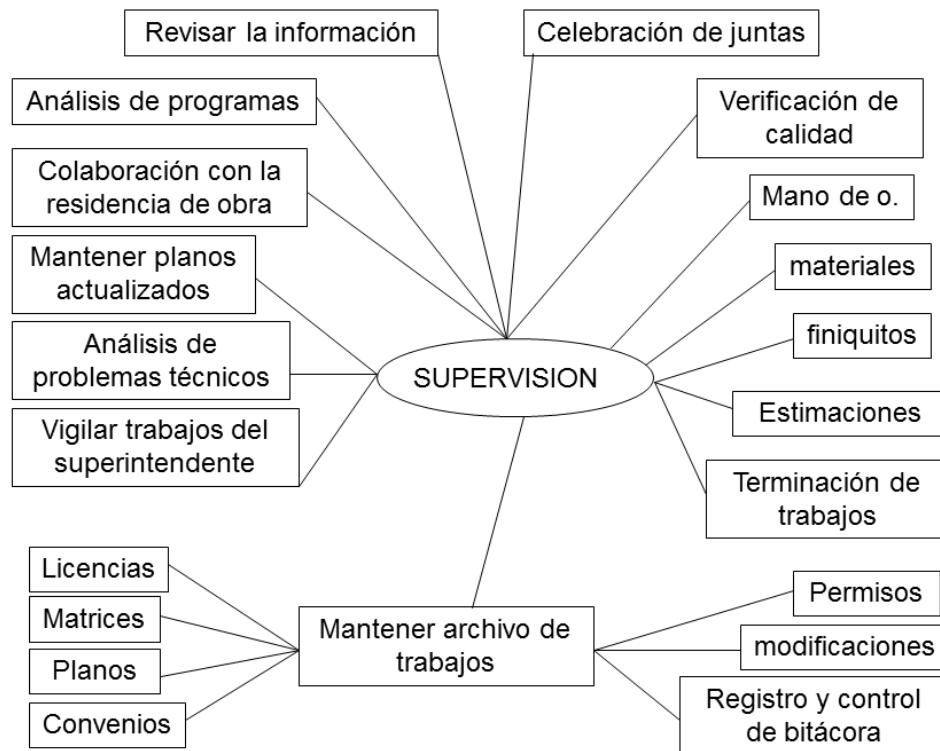
Ilustración 53 Responsabilidades del Supervisor de Obra (Quijano Valdés, 2015)
