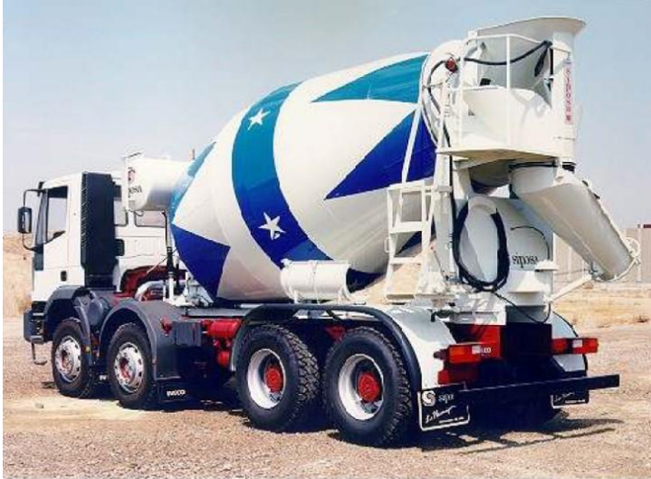
Ilustración 23 Camión Concretero (Manual de Procesos Constructivos, 2005)
