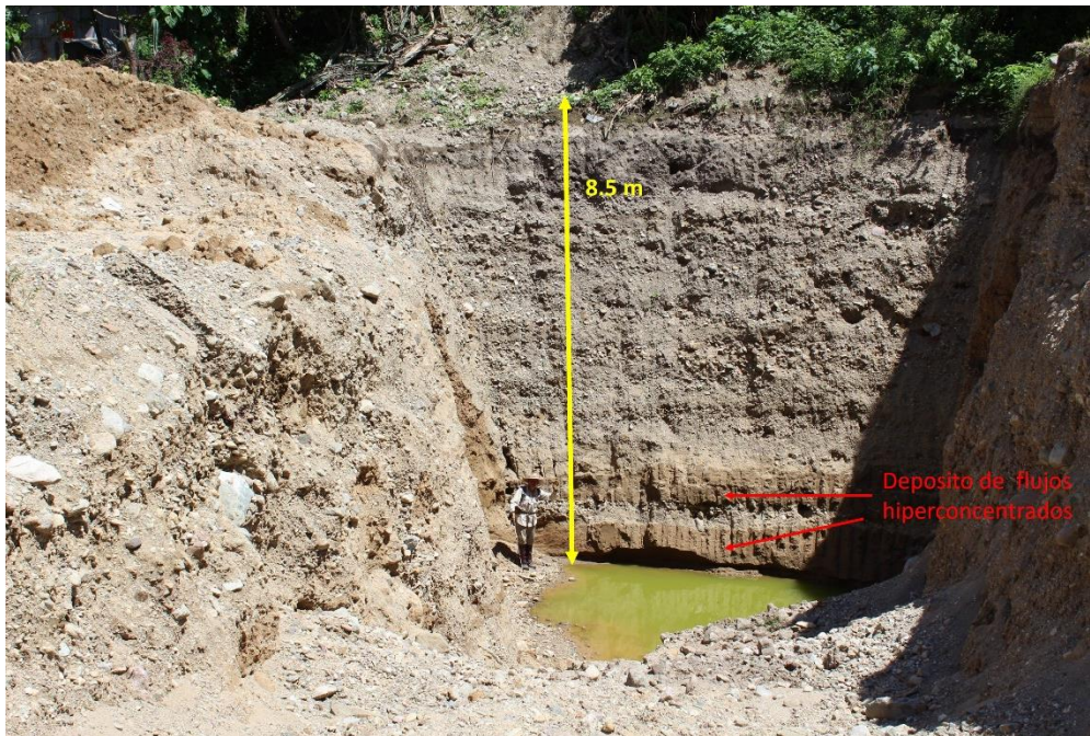
Figura 39. Columna estratigráfica de los depósitos sobre el cauce del Río Xelajú, a la altura de la zona Urbana
