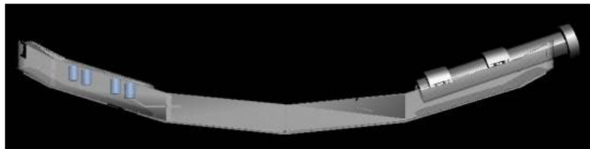
Vista superior del retrovisor donde se observan las torretas (azul) situadas en el interior de la carcasa
