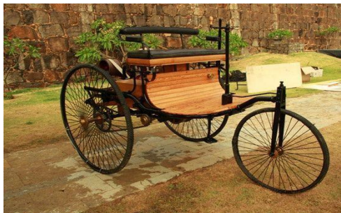
-Benz Patent Motorwagen. El vehículo de tres ruedas utilizaba ruedas de alambre similares a las de las bicicletas en 1885
