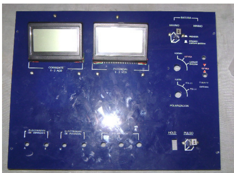
Figura 99. Multímetros en el acrílico.
