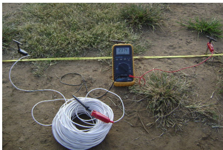
Figura 61. Medición de potencial natural.
