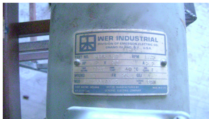
Figura A.1. Generador de C.D. de imanes permanentes.
