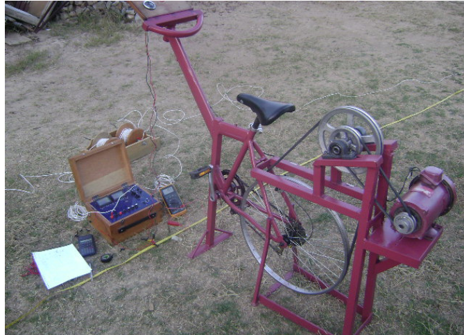
Figura A.2. Generador acoplado a una bicicleta.
