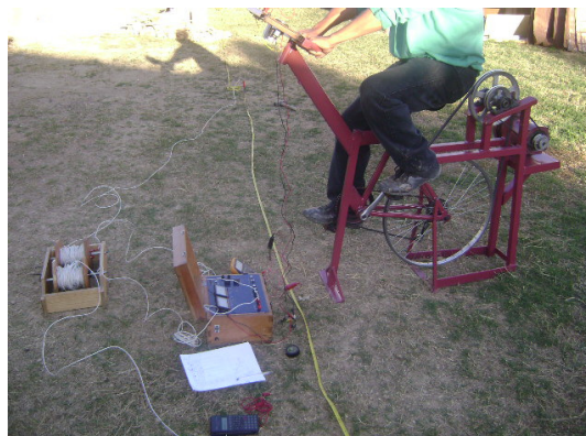
Figura A.6. La fuente mecánica que proporciona el voltaje de entrada.
