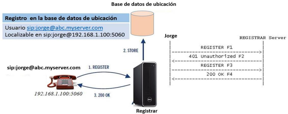
FIGURA 2.8. FUNCIONAMIENTO DEL SERVIDOR DE REGISTRO (REGISTRAR).
