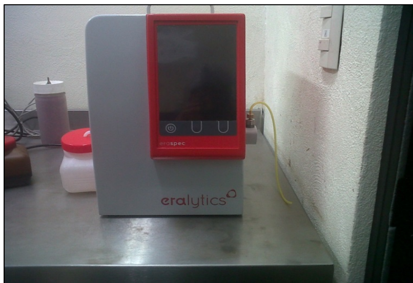
Figura 3.2 Analizador IR marca Eralytics para la determinación del Índice de Octano
