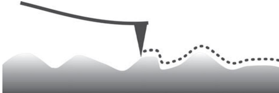
Figura 2-5 En modo contacto, la punta sigue directamente la topografía de la superficie mientras es barrida.
