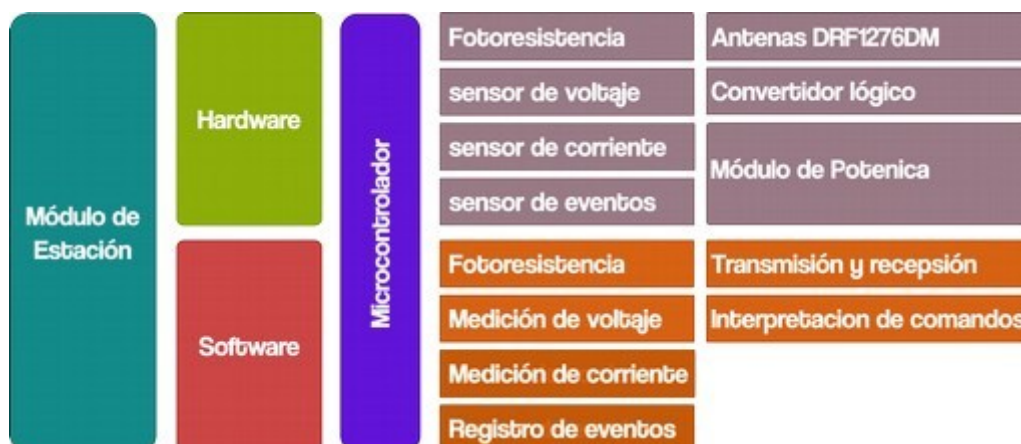
Figura 4.3 Resumen de integración de Módulo Estación.
