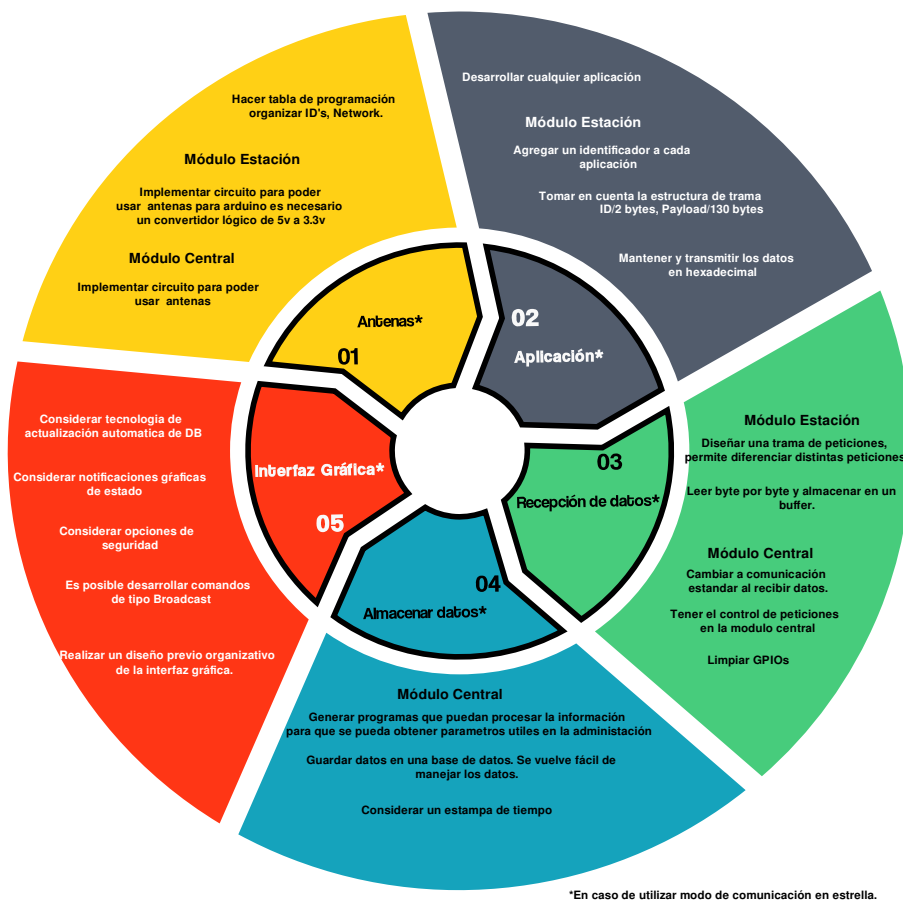
Figura 6.1.: Diagrama de resumen de puntos a revisión en la implementación de un proyecto similar con tecnología LoRa.
