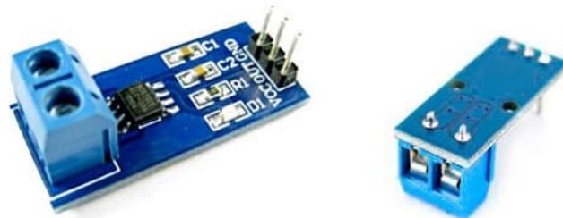
Figura A.4: Modulo ACS712, Sensor de Corriente.
