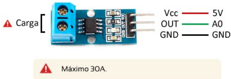
Figura A.5: Distribución de pines de ACS712.
