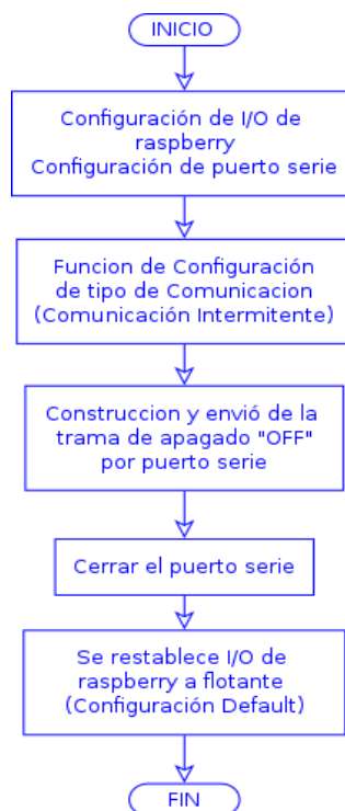
Figura 4.22 Diagrama de Flujo de transmisión de datos para apagado de lamparas .
