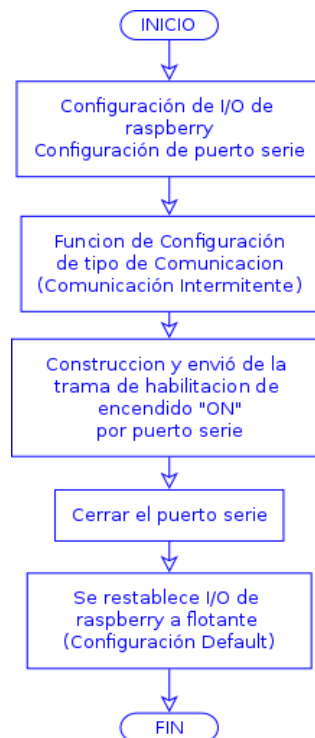
Figura 4.23 Diagrama de Flujo de transmisión de datos para habilitación de encendido de lamparas.
