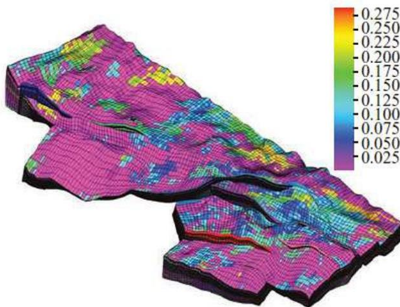
Figura 51- Ejemplo de un mapa de porosidad generado por la integración de la información obtenida de pozos y datos sísmicos.
