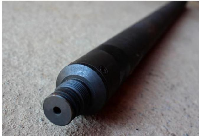
Figura 33: Cortador severing tool
