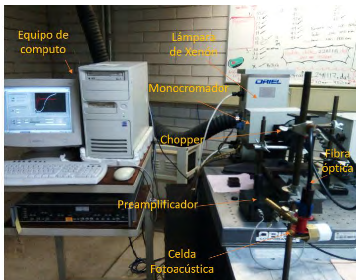
Figura 3.33. Montaje de Espectroscopia Fotoacústica (EFA) en Cinvestav-campus C.d de México, (Elaboración propia, 2018).
