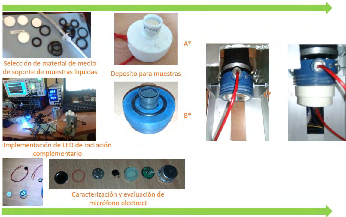
Figura 3.28. Sistema FA etapa de rediseño y modificaciones
