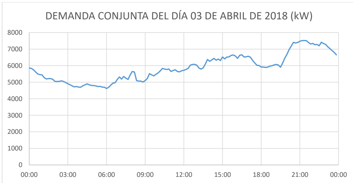
Figura 4.7: Demanda eléctrica que proveen los circuitos TRN 4060 y TDD 4050 para el día 3 de abril de 2018.
