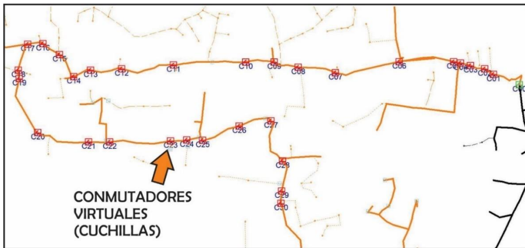
Figura 5.17: Ubicación de los conmutadores virtuales para el desarrollo de la prueba 2.
