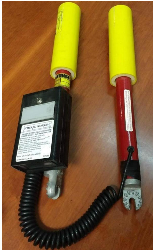
Figura 3.3: Medidor de voltaje que se maneja mediante pértigas aisladas, con él se puede verificar la diferencia de tensión entre ambos circuitos.
