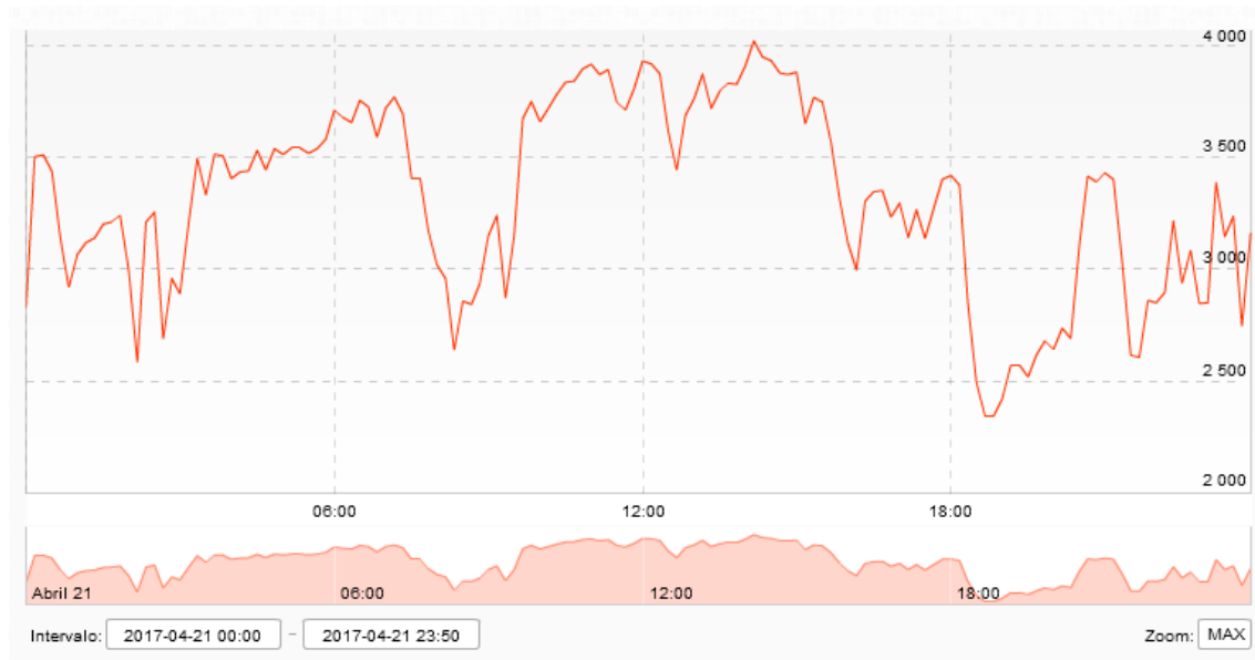
Figura 2.16: Perfil de demanda del circuito COP 4070, cuya carga predominante es industrial.
