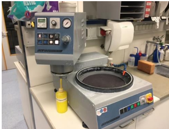
Figura 3.10 Pulidora automática marca ATM modelo SAPHIR 350 con brazo ATM modelo RUBIN 520.
