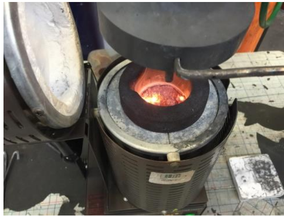
Figura 3.2 Crisol de grafito montado en el horno eléctrico.
