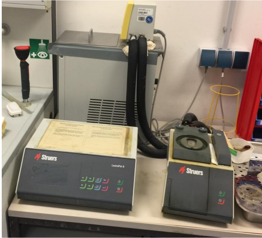
Figura 3.16 Electropulidora Lectro Pol 5 de la marca Struers.
