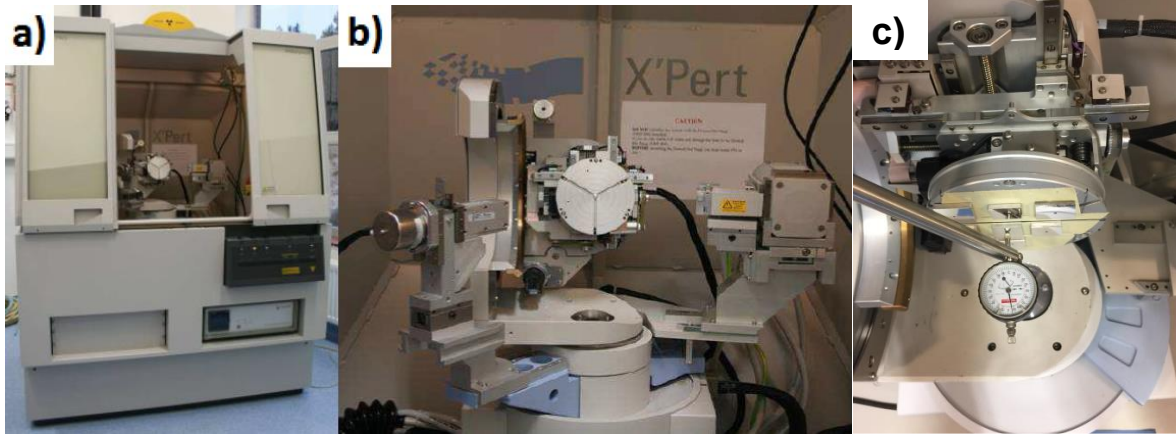
Figura 3.12 a) Equipo de difracción de rayos X [26], b) y c) goniómetro de texturas PANalytical Xpert™, utilizado en el HZG
