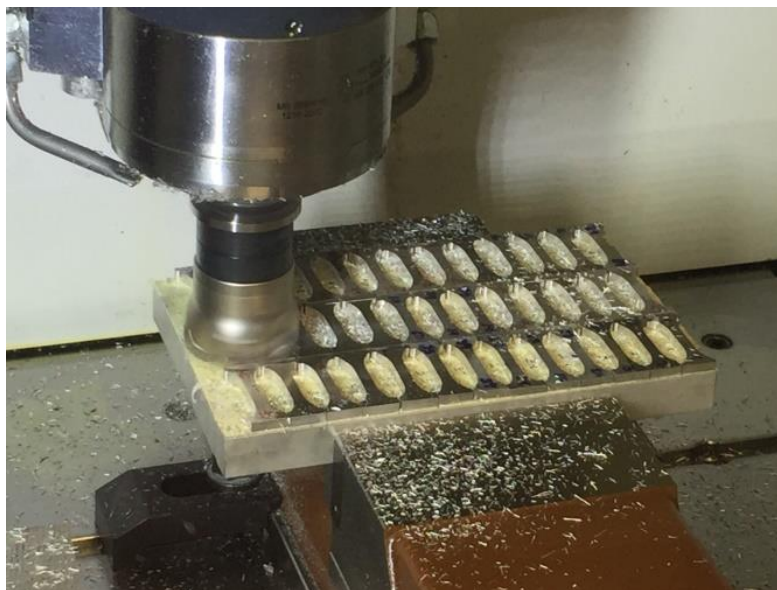
Figura 3.13 Maquinado de probetas.
