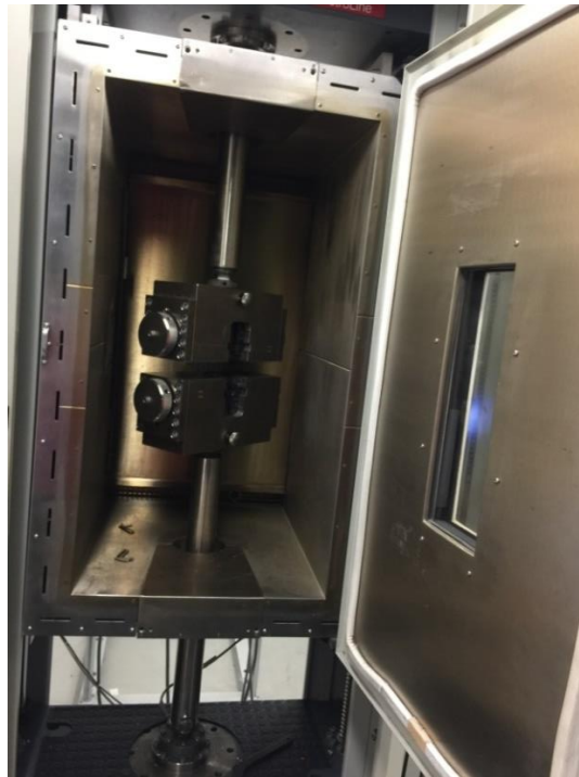
Figura 3.15 Máquina de ensayos universales marca Zwick Z050.
