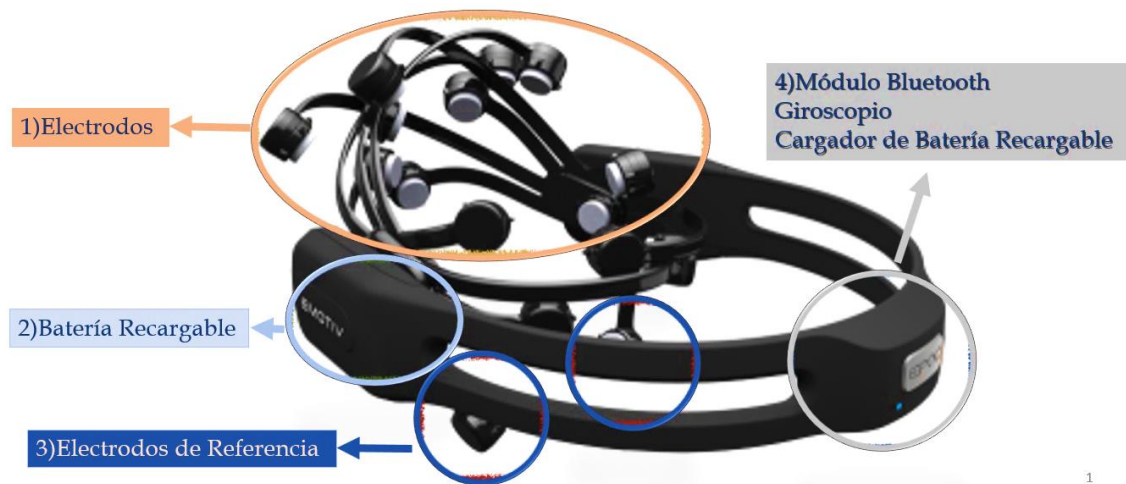
FIGURA 2. 2- ICC EMOTIV EPOC+ DONDE SE MUESTRA, 1) POSICIONAMIENTO DE LOS ELECTRDOS, 2) BATERÍAS RECARGABLES, 3) ELECTRODOS DE REFERENCIA, 4) MODULO BLUETOOTH, GIROSCOPIO Y CARGADOR DE BATERÍAS.
