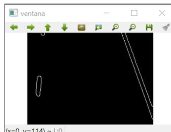
Figura 2.11. Resultado de aplicar el método Canny para detección de bordes a la imagen previamente segmentada.
