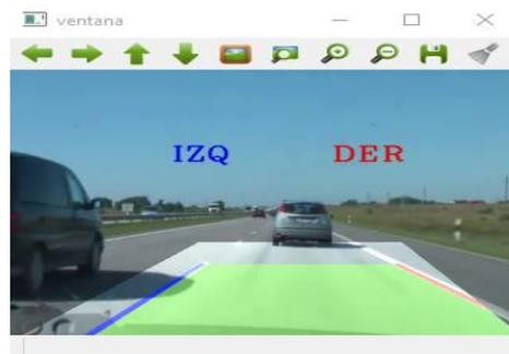
Figura 2.16. Resultado final de la detección de carriles.
