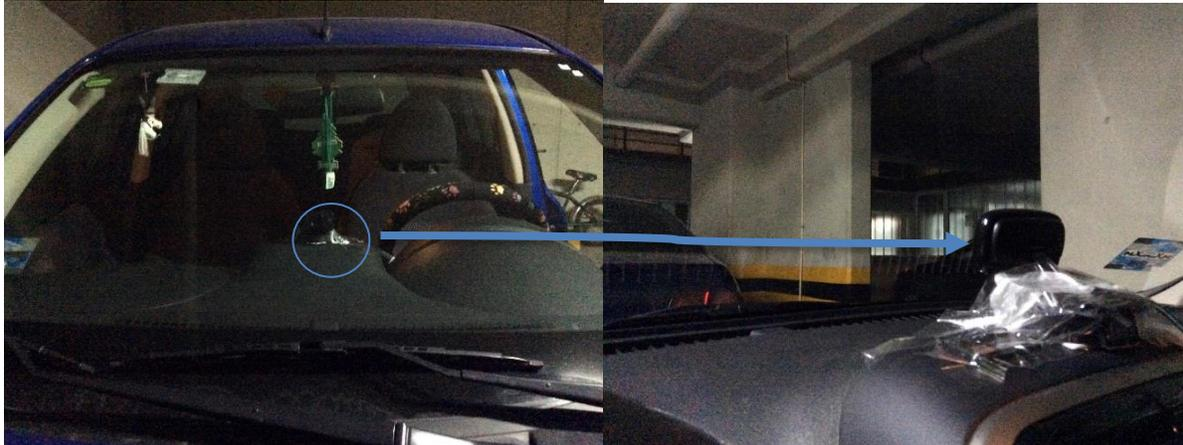
*Figura 4.6. Fotografías de la colocación de la video cámara.*
