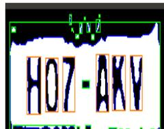
*Figura 3.12. Pasos para detectar los caracteres de la matrícula: a) detección de contornos (en azul). b) encerrando los contornos dentro de rectángulos (color verde).c) selección de los rectángulos que contengan a los caracteres (color naranja).*
