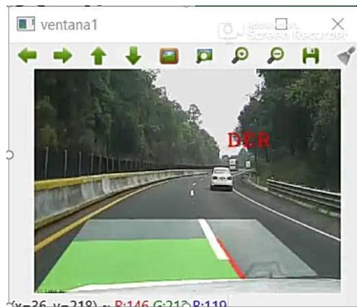
Figura 4.4. Dificultad de detectar la línea del carril izquierdo debido a la curvatura de la carretera.
