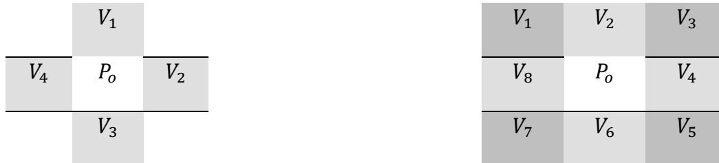
Figura 6. Definición de la vecindad de un pixel P de 4 vecinos y 8 vecinos Fuente: Procesamiento de digital de imágenes con Matlab y Simulink, 2010.
