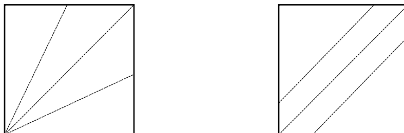
Figura 15. Representación gráfica del mapeo que se genera en el pixel resultante I'(x, y) al modificar los valores de la ecuación para (a) c y (b) b .
