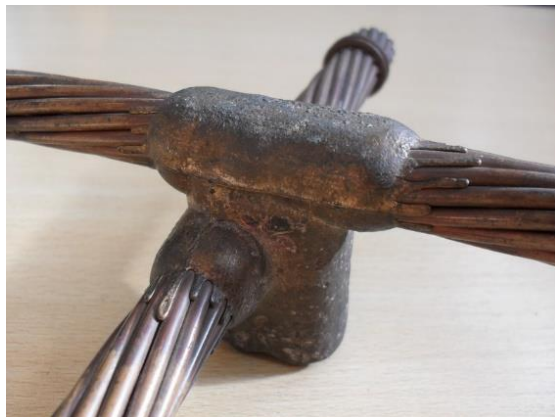
Figura 1. 17. Conexión de fusión (DHEG de México, 2015).
