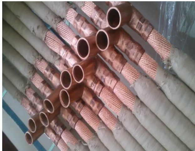
Figura 1.18. Conectores de compresión (DHEG de México, 2015).
