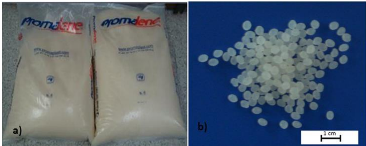
Figura 17.- a) Ácido Poliláctico comercial y b) aspecto de los pellets
