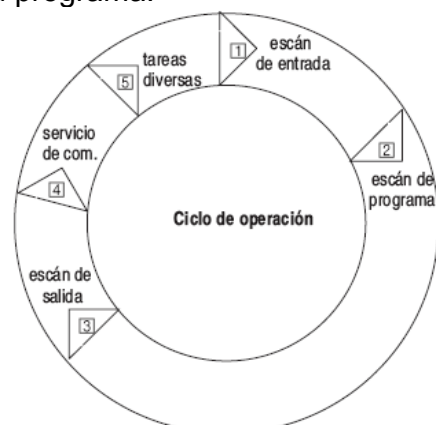
Fig. 4.12.2 ciclo de operación del MicroLogix
