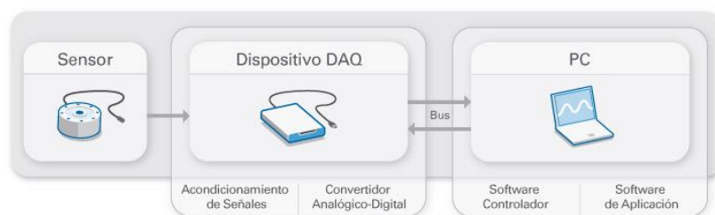
Figura 17: Estructura básica de un sistema DAQ[21]
