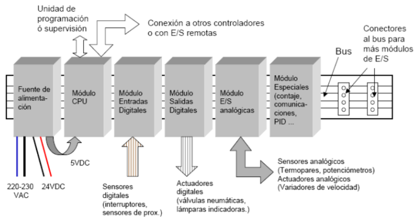
Figura 18: Estructura básica de un PLC [22].
