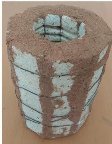
Figura 60. Pared de ladrillos fijada con mortero y alambre recocido.
