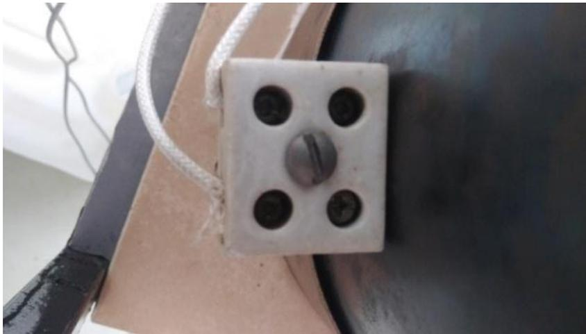
Figura 63. Bloque cerámico de la resistencia
