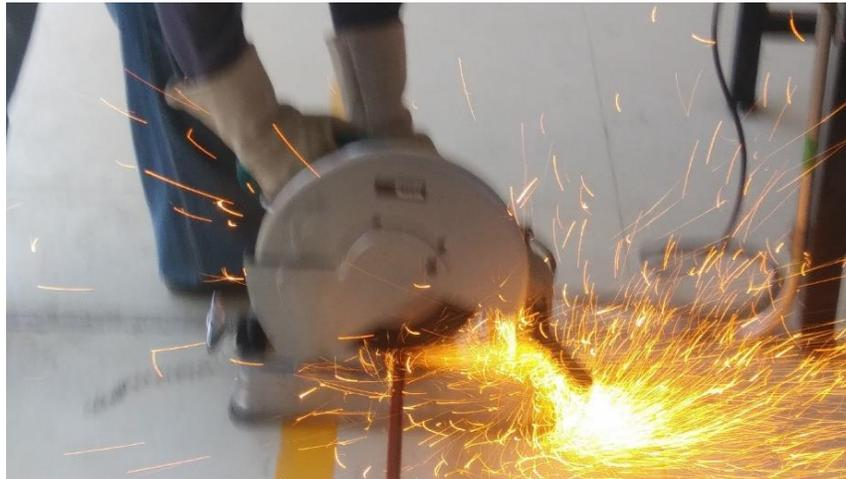
Figura 55. Corte de perfil tubular.
