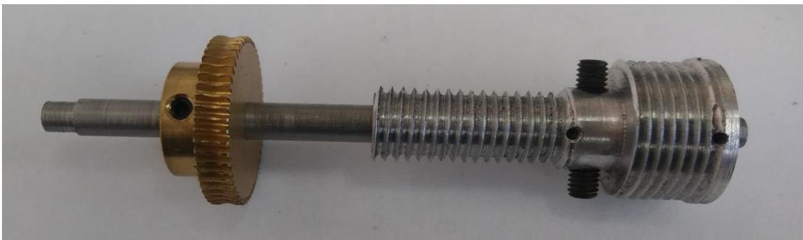
Figura 70. Ensamblaje de elementos del segundo eje de transmisión.
