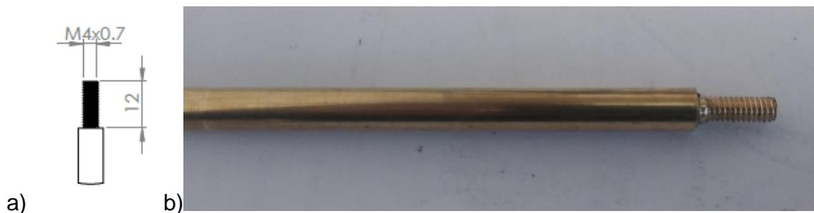
Figura 67. Barra guía: (a) Diagrama de medidas de la rosca externa, (b) producto final.
