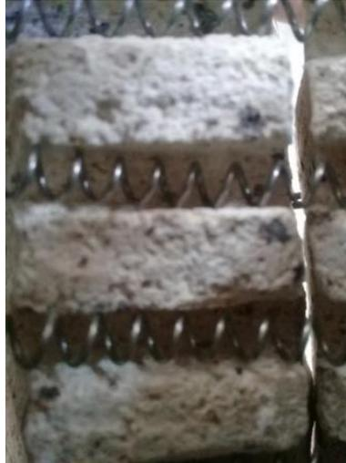
Figura 61. Resistencia dentro de las ranuras del horno.
