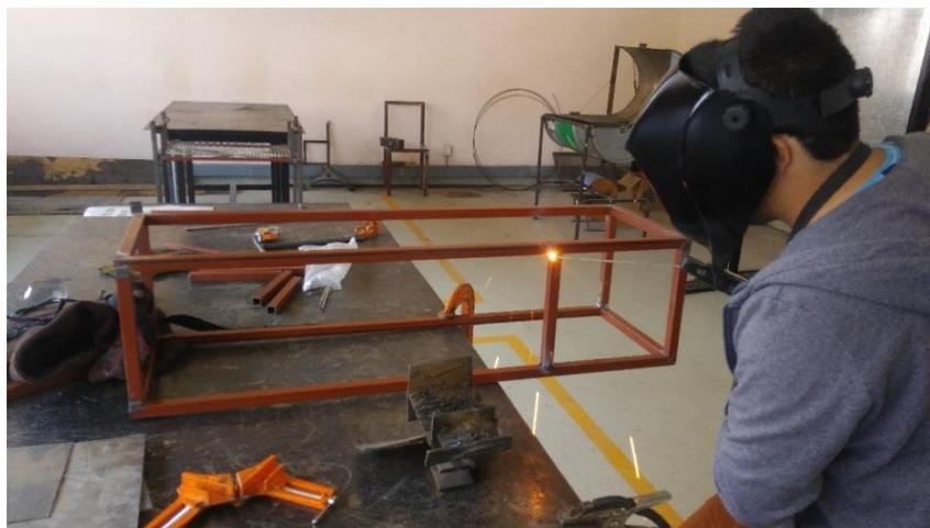
Figura 56. Realización del proceso de soldadura en el perfil tubular.
