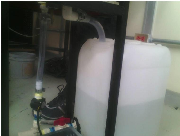
Figura 66. Conexión entre el bidón y el recipiente de acrílico.
