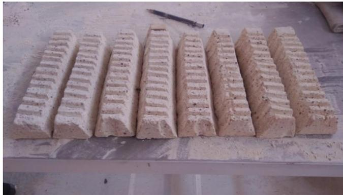
Figura 59. Ladrillos refractarios cortados y ranurados.
