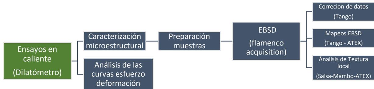
Figura 3.3.- Diagrama de flujo del procedimiento experimental
