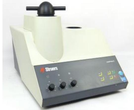
Montadora: Struers Labpress 3
