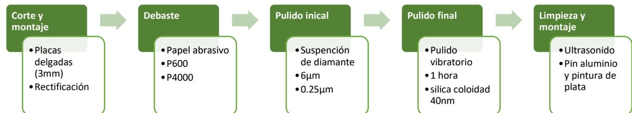
Figura 3.4.- Preparación de probetas para análisis con EBSD
