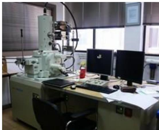
Figura 3.6.- Microscopio electrónico de barrido JEOL JSM-7001F, UPC Barcelona.
