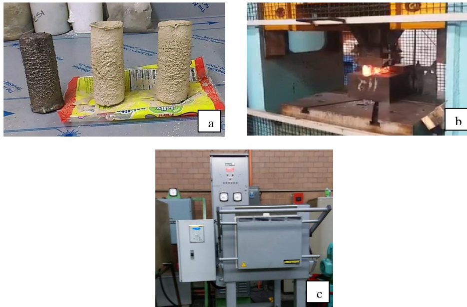
Figura 3.3. Procesamiento termomecánico a) preparación de lingotes, b) prensa para deformación en caliente y c) mufla para tratamientos térmicos.
