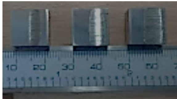
Figura 4.26. Probetas de desgaste del acero 18Mn después de la prueba de desgaste
