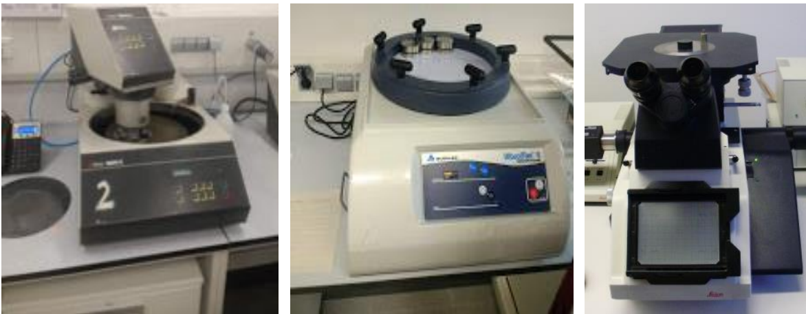
Figura 3. 6. Equipo del laboratorio de metalografía de la UPC a) pulidora mecánica, b) pulidora vibratoria y c) microscopio metalográfico.
