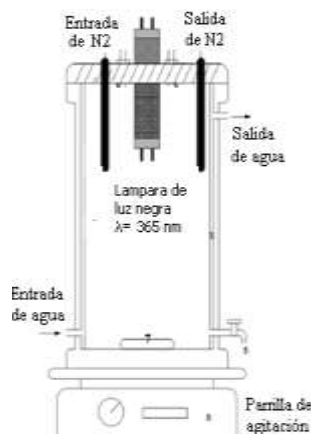
Figura 2.3 Sistema de reacción del método de descomposición foto-química. Lámpara de luz negra ( \lambda=365 nm) de 20 \text{ W/cm}^2
