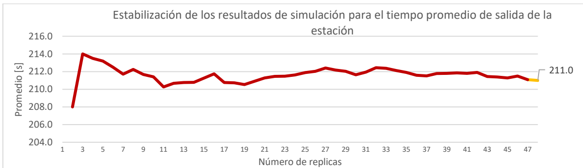
Figura E.2 Estabilización de los resultados de simulación para el tiempo promedio de salida de la estación Merced de conformidad con el escenario 1
