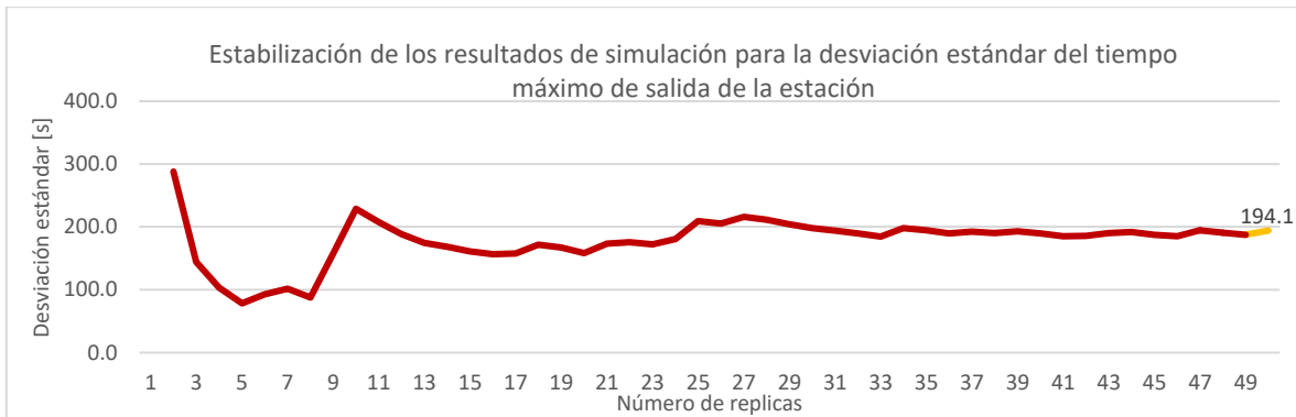
Figura E.19 Estabilización de los resultados de simulación para la desviación estándar del tiempo máximo de salida de la estación Guerrero de conformidad con el escenario 5
