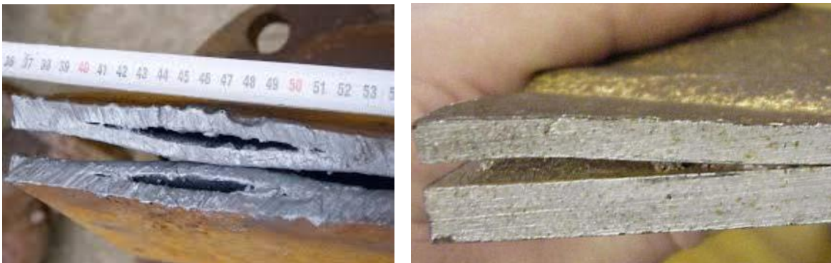
Figura 1. Laminaciones simples contenidas en el espesor de placas metálicas de acero con bajo contenido de carbono.
