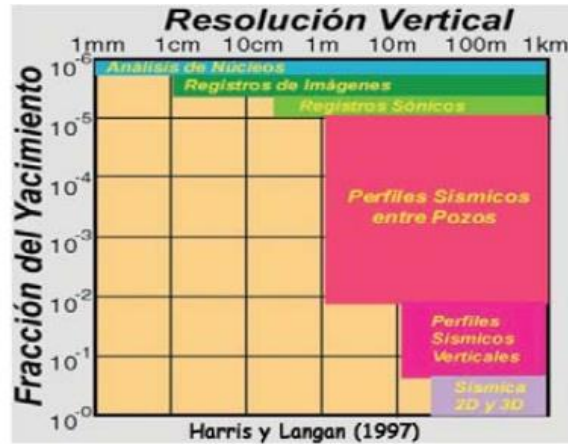
Figura 3.5. 4. Variación de la resolución vertical asociada con las diferentes técnicas de exploración geofísica, con respecto a la fracción detectable de yacimientos de hidrocarburos (modificado de Harris y Lagan, 1997)
