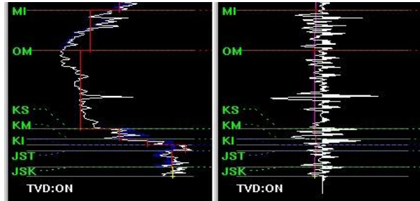
Figura 4.2. 10. Zona donde se aprecia un cambio brusco en las velocidades atribuido a la zona de presiones anormales en el programa SynTool de Landmark®.
