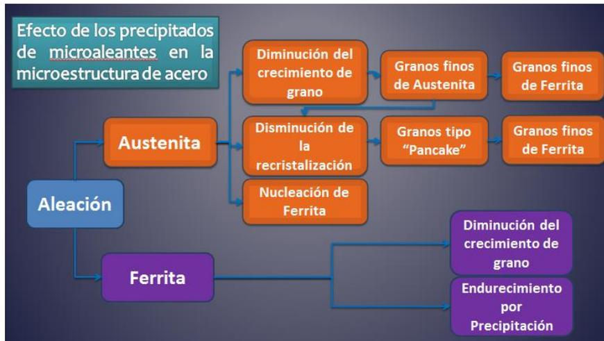
Figura 2. 10 Efecto de los precipitados de microaleantes en la microestructura del acero HSLA sobre la austenita y la ferrita.
