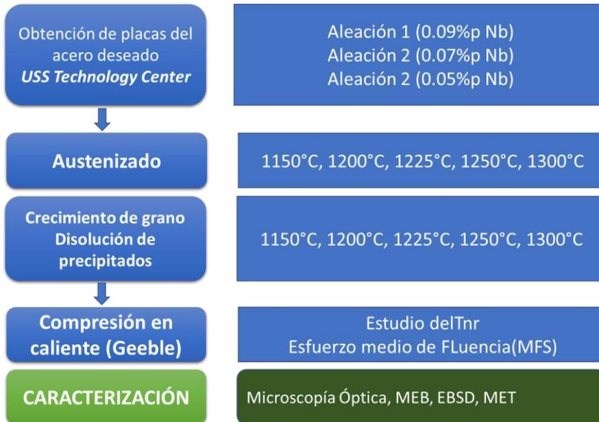
Figura 3. 2 Metodología seguida, incluyendo las pruebas de crecimiento de grano y el procesamiento termomecánico de los aceros HSLA.
