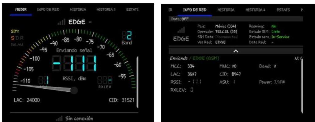
Figura. 2-15. Mediciones de la señal de EDGE en la ubicación de la RBS.
