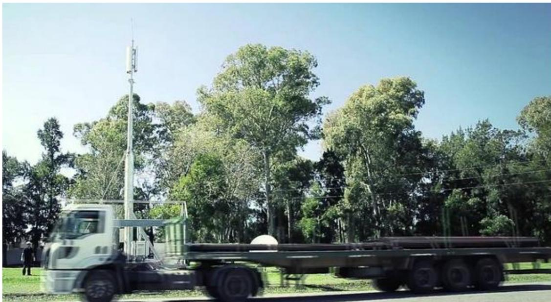
*Figura. 3-14. Radio Base móvil con su propio motor.*
